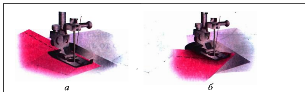
Рис. 38. Выполнение поворота строчки под углом: а — лапка опущена; б — поворот ткани при поднятой лапке
