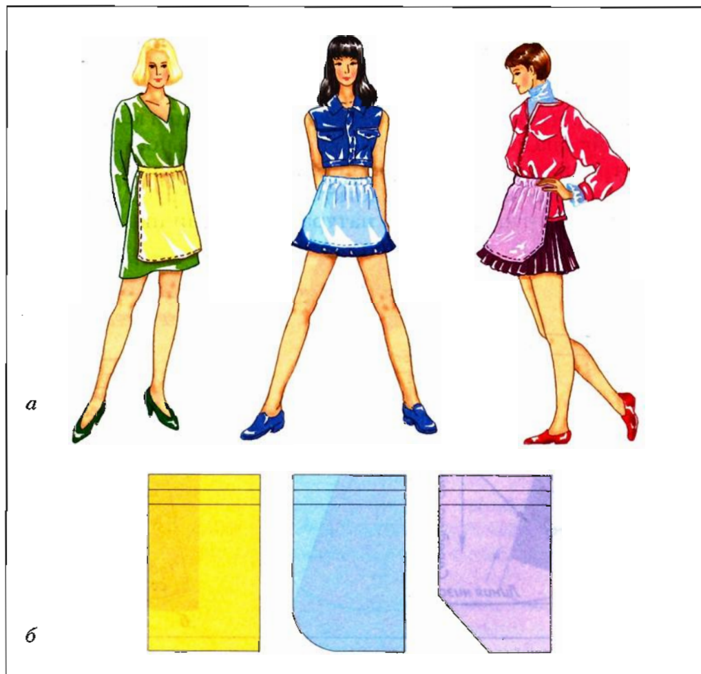
Рис. 20. Моделирование фартука: а — модели; б — выкройки
